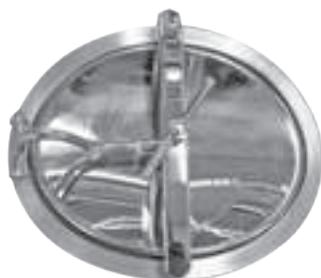
Cadre plat & embouti **CALANDRABLES** à la demande pour épouser parfaitement des galbes de cuves à partir de diamètre 1400 mm. Le cadre se rapporte par l'extérieur, simplifiant ainsi les opérations de découpe, et assure une aseptic par absence de zone de rétention à l'intérieur de la virole.
