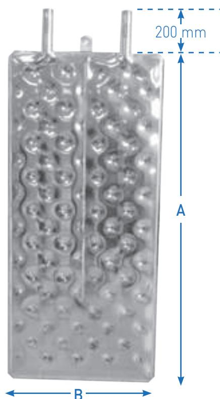
L'échangeur drapeau plan TRANSFLUID permet, grâce à ses nids d'abeilles, de maîtriser la vitesse de circulation du fluide (eau glacée, froide ou chaude) quel que soit le nombre d'échangeurs en demande sur l'installation.
