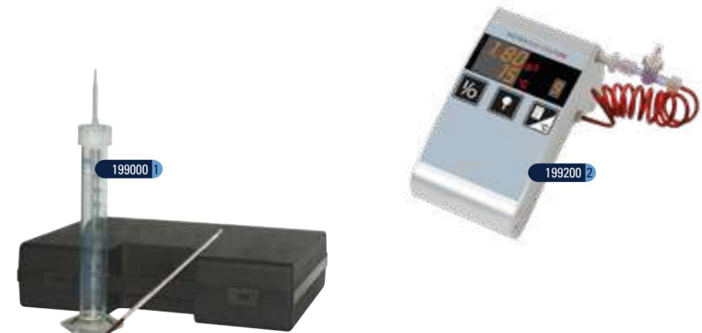
**1 199000 Carbodoseur.** Cette méthode est la plus simple et la plus adaptée au contrôle de chai du CO<sub>2</sub> dissous. Elle s'effectue à l'aide d'une éprouvette bouchée, préalablement remplie de l'échantillon à doser, qui une fois agitée laisse s'échapper un certain volume d'échantillon, en relation avec la teneur en CO<sub>2</sub>. Précision de l'ordre de 50 mg/l. Livré complet en mallette avec table de correspondance.
